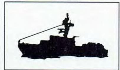
Länge 27,5 m, Breite 6,53 m, Tiefgang 1,65 m; ausgerüstet mit: 3 Propellern 781 - 1632 - 781 = 3194 PS, Funk, Echolot, Radar, Funkpeiler, GPS, Decca, Homing, Selbststeueranlage, Videoplotter, Fremdenanlage, Hospital, Feuerlöschanlage
